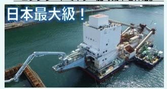
コンクリートミキサー船は海上でコンクリートを打設する 作業船のことで、当工事で活躍している「第十七神昭」は長 さ60m、幅22m、高さ26mと、国内最大級(!)のコンク リートミキサー船です。神戸港から千葉県館山港を経由し、 気仙沼湾に入港しました。
